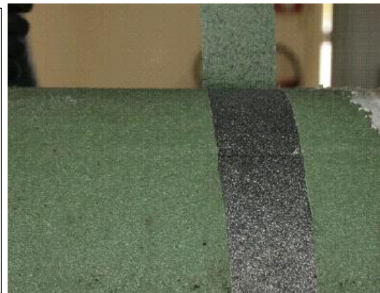
Figure 7 : Pelage d'un revêtement FBE + adhésif vieilli 28 j dans l'eau déionisée à 60°C
